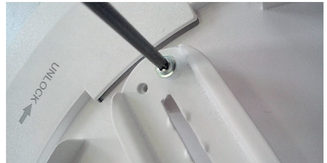
Abb. 2: Trägerplatte an der Rückseite festschrauben
