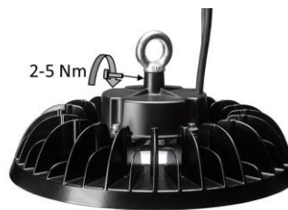
Abb. 5: Gewindeöse fixieren
