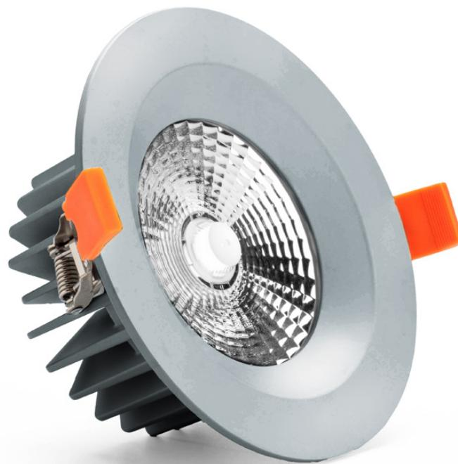
Symmetrisch abstrahlendes Einbau-Downlight für ein Lochmaß von 115-140 mm, Einbautiefe 67 mm, Einbauring aus Aluminiumdruckguss in silber, andere Adapter-Ringe für größere Deckenausschnitte auf Anfrage, Glas-Abdeckung, gefrostete Glas-Abdeckung auf Anfrage, Spiegelreflektor 99,98 % mit verschiedenen Abstrahlwinkeln, verschiedene Lichtfarben, auch höhere Farbwiedergabe, Leistungsaufnahme von 22 W individuell einstellbar, LED Treiber (IP65) inklusive.
