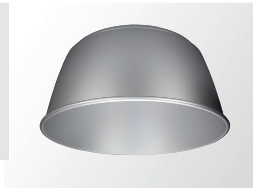
Reflektor CORONA, Ø 580 x H 270 mm, silber, nachträgliche werkzeuglose Montage, UGR 21
