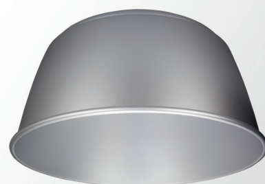
Reflektor CORONA, Ø580 x H 270 mm, silber, nachträgliche werkzeuglose Montage, UGR 21
